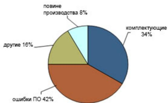
Наибольшее число отказов в общем количестве отказов пожарной и охранно-пожарной сигнализации – по причине завода-изготовителя.
